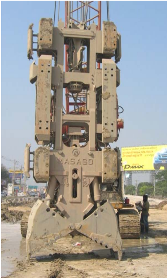
รูปที่ 3-9 เครื่องจักรขุดดินสำหรับก่อสร้างผนังพืดแบบ Cable Hang Grab
