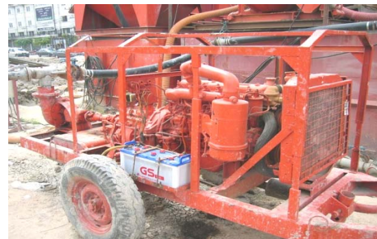
รูปที่ 3-13 เครื่องสูบลำลายพองเสถียรภาพเข้าไปในหลุมชุด ขนาดเส้นผ่านศูนย์กลางท่อ 4"
