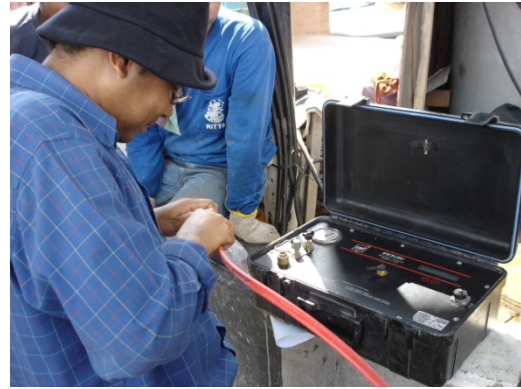
ข. ภาพแสดงเครื่องมืออ่านค่าแรงดันน้ำ
