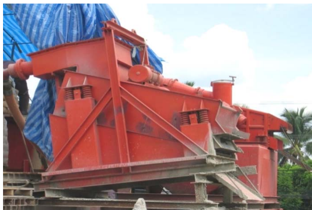
รูปที่ 3-10 เครื่องแยกตะกอนทรายออกจากสารละลายพุงเสถียรภาพ (Desander Unit)
