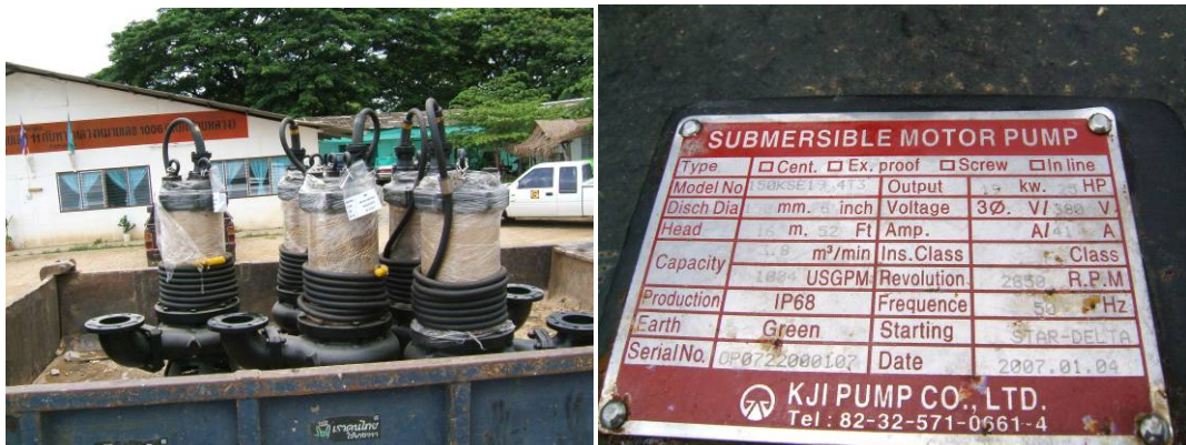
รูปที่ 6-3 เครื่องสูบน้ำแบบ Submersible Sewage Pump ที่ใช้ในโครงการฯแยกปอยหลวง
