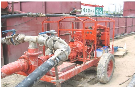
รูปที่ 3-13 เครื่องสูบลำลายพองเสถียรภาพเข้าไปในหลุมชุด ขนาดเส้นผ่านศูนย์กลางท่อ 4"
