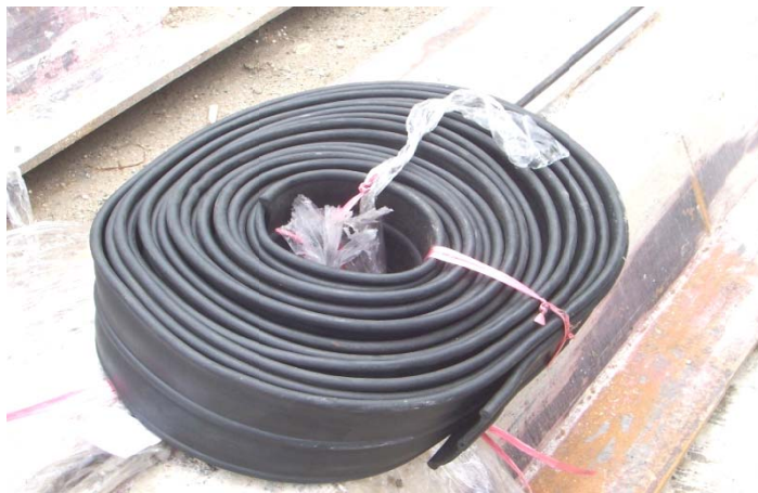
รูปที่ 3-19 แผ่นยางกันน้ำรั่วซึม (Water Stop)
