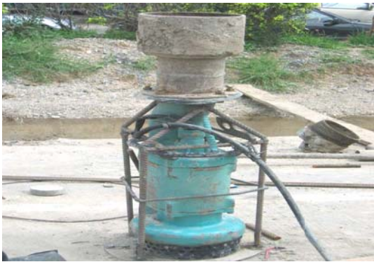
รูปที่ 3-12 เครื่องสูบลำลายพองเสถียรภาพออกจากหลุมชุด ขนาดเส้นผ่านศูนย์กลางท่อ 8"
