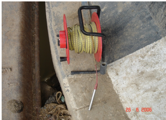
รูปที่ 9-4 เครื่องมือที่ใช้อ่านค่าระดับน้ำจากผิวดิน
