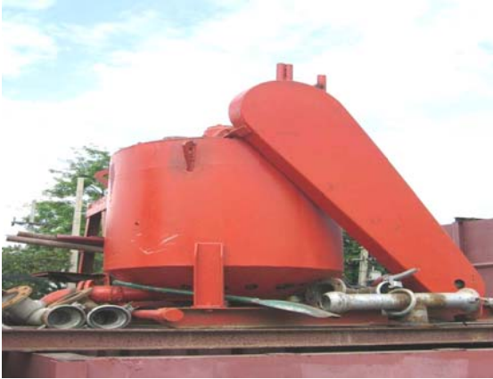
รูปที่ 3-11 เครื่องผสมสารละลายพองเสถียรภาพ
