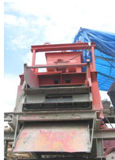
รูปที่ 3-10 เครื่องแยกตะกอนทรายออกจากสารละลายพุงเสถียรภาพ (Desander Unit)
