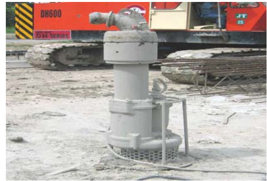
รูปที่ 3-12 เครื่องสูบลำลายพองเสถียรภาพออกจากหลุมชุด ขนาดเส้นผ่านศูนย์กลางท่อ 8"
