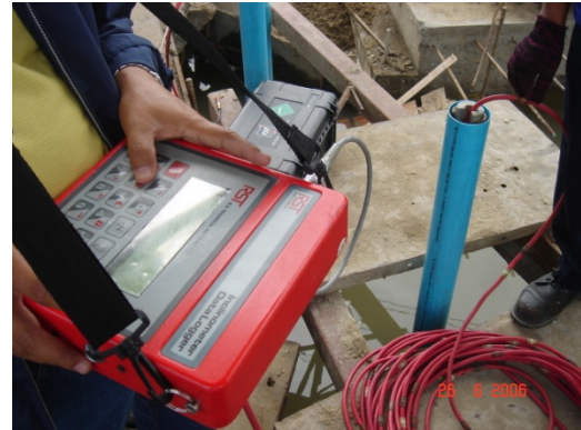
ข. ภาพแสดงเครื่องอ่านค่าการเอียงตัว (Readout)
