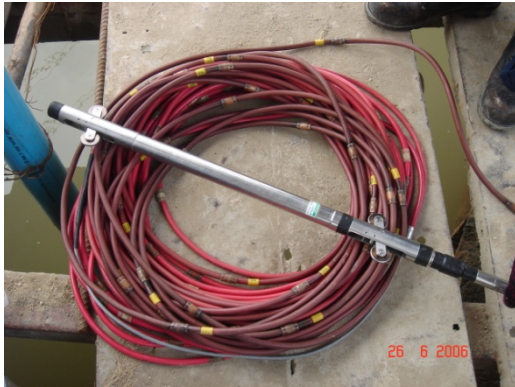
ก. ภาพแสดงสายนำสัญญาณและหัววัด การเคลื่อนตัว (Probe)
